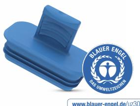
Der Kontaktschutz GPN 366 dient dem Schutz von Kompaktstecker-Anschlüssen im Niedervolt-Bereich und ist ebenfalls geeignet für ovale Öffnungen. Die handliche Grifflasche sorgt für eine schnelle Demontage und die umlaufenden Lamellen ermöglichen einen optimalen Klemmsitz. Innerhalb gewisser Grenzen verhindert der Kontaktschutz den Eintritt von Flüssigkeiten.
