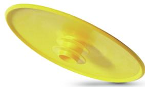
Die Flanschabdeckungen GPN 670 schützen Flansche nach DIN EN 12351 vor Beschädigung und Verschmutzung, verschließen die Öffnung und deckt Dichtleisten und Schraublöcher ab. Lamellen überbrücken größere Toleranzen. Im Gegensatz zu den meisten anderen Flanschabdeckungen ist die sichtbare Außenseite der Flanschabdeckung ohne Vertiefung in der Mitte und somit eben ausgeführt – dies sorgt für eine ansprechende Optik.
