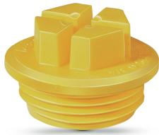
Die Dichtstopfen GPN 736 sind passend für das Verschließen von Einschraublöchern nach DIN 3852-1 und ISO 11926 und sind besonders geeignet für Prozesse wie Reinigen, Prüfen, Lackieren oder auf dem Transport. Das robuste Material ist hochwertig und besonders schlagzäh. Die umlaufende Dichtlippe verhindert innerhalb gewisser Grenzen das Eindringen und Auströten von Flüssigkeiten. Die Montage erfolgt durch Schraubendreher oder Schraubenschlüssel.
