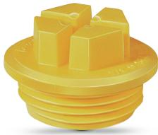
Les bouchons filetés GPN 736 conviennent pour couvrir les filetages conformément aux normes DIN 3852-1 et ISO 11926. Ils sont particulièrement adaptés à des processus tels que le nettoyage, les tests, la peinture ou le transport. Ce matériau robuste et de haute qualité est particulièrement résistant aux chocs. La lèvre d'étanchéité périphérique empêche, dans certaines limites, la pénétration et l'écoulement de liquides. Le montage s'effectue à l'aide d'un tournevis ou d'une clé à vis.
