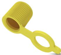
Les capuchons de protection pour graisseurs GPN 980 version B conviennent pour protéger les graisseurs coniques conformément à la norme DIN 71412 et sont dotés d'une languette pour éviter de les perdre. La paroi extérieure est dentelée pour faciliter le montage et le démontage.
